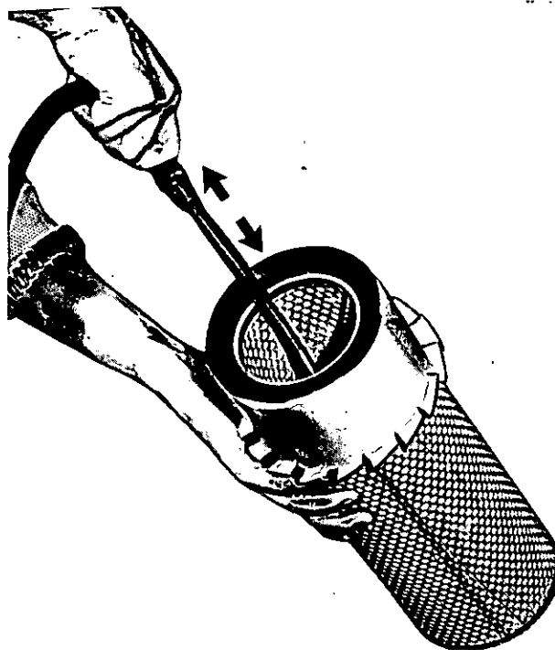
Fig. 57 - Pulizia della cartuccia filtrante mediante aria compressa
